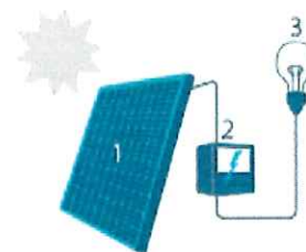
1. Zonnepaneel | 2. Omvormer | 3. Elektrische toestellen
